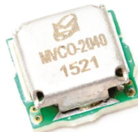
MVCO-2040-SF — октавный генератор, предназначенный для генерации сигнала гигагерцового диапазона частот с последующей стабилизацией ФАПЧ. MVCO-2040-SF могут использоваться в измерительной, связной и радиолокационной технике. Тщательно проработанная конструкция позволяет обеспечить высокую повторяемость параметров, надежность и низкую стоимость при массовом производстве.
